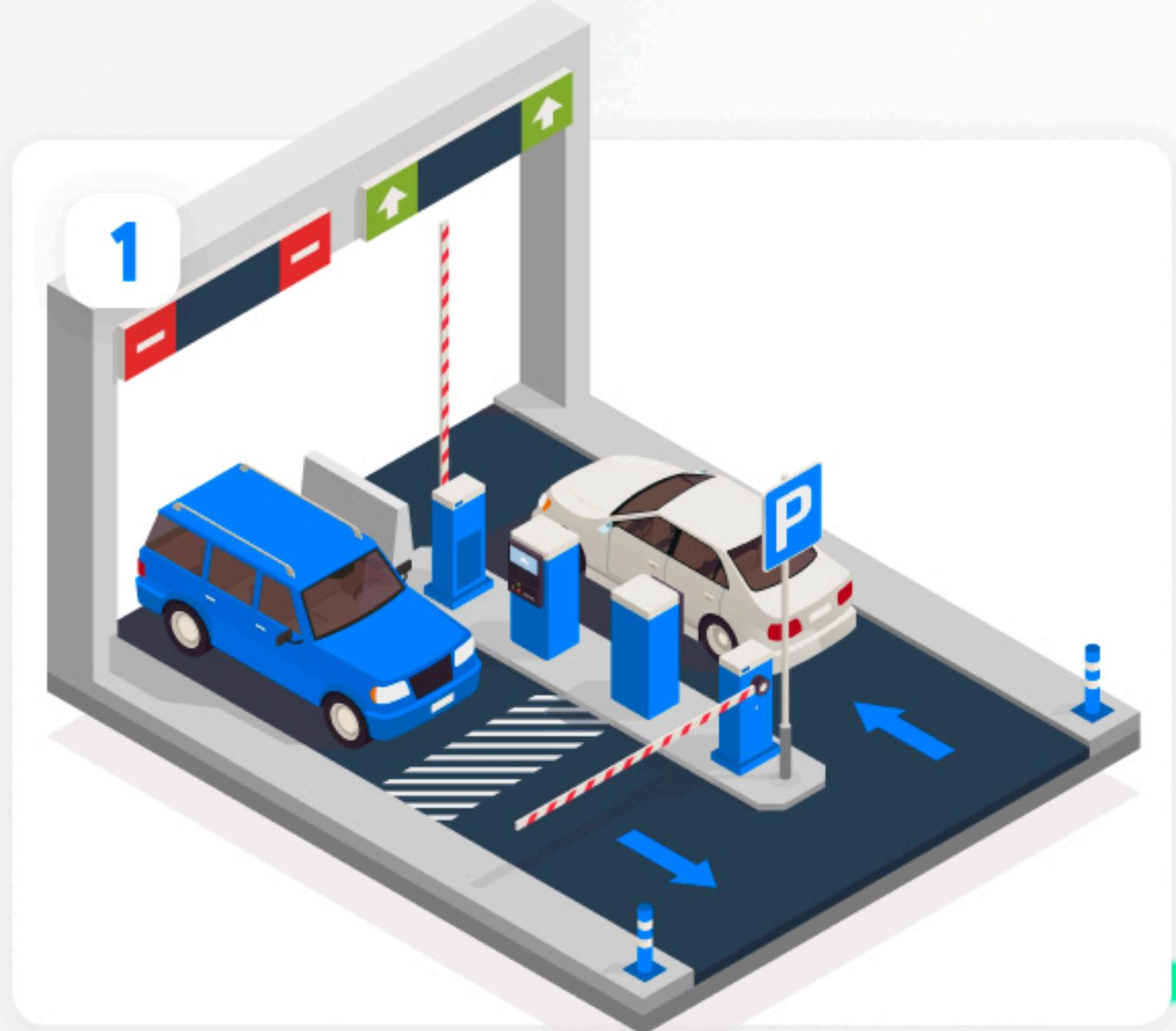
КАМЕРА СЧИТЫВАЕТ НОМЕР НА ВЪЕЗДЕ\ВЫЕЗДЕ
